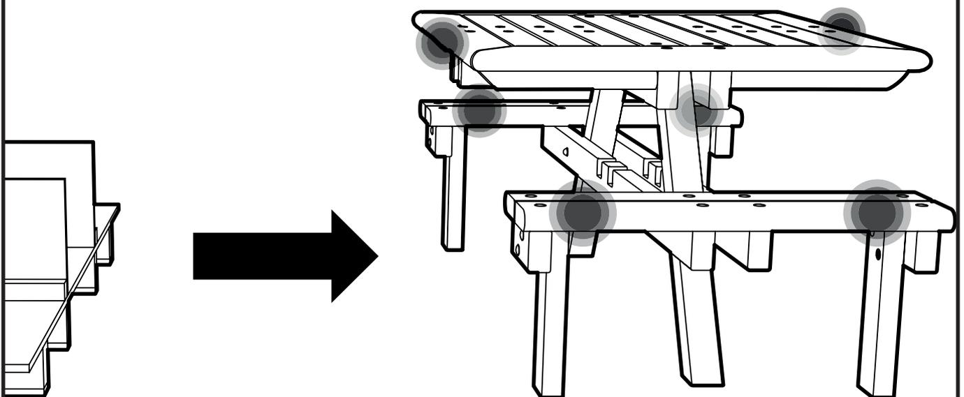
4. Coloque la mesa con cuidado en el lugar deseado, levantándola de los puntos marcados en la ilustración superior.
