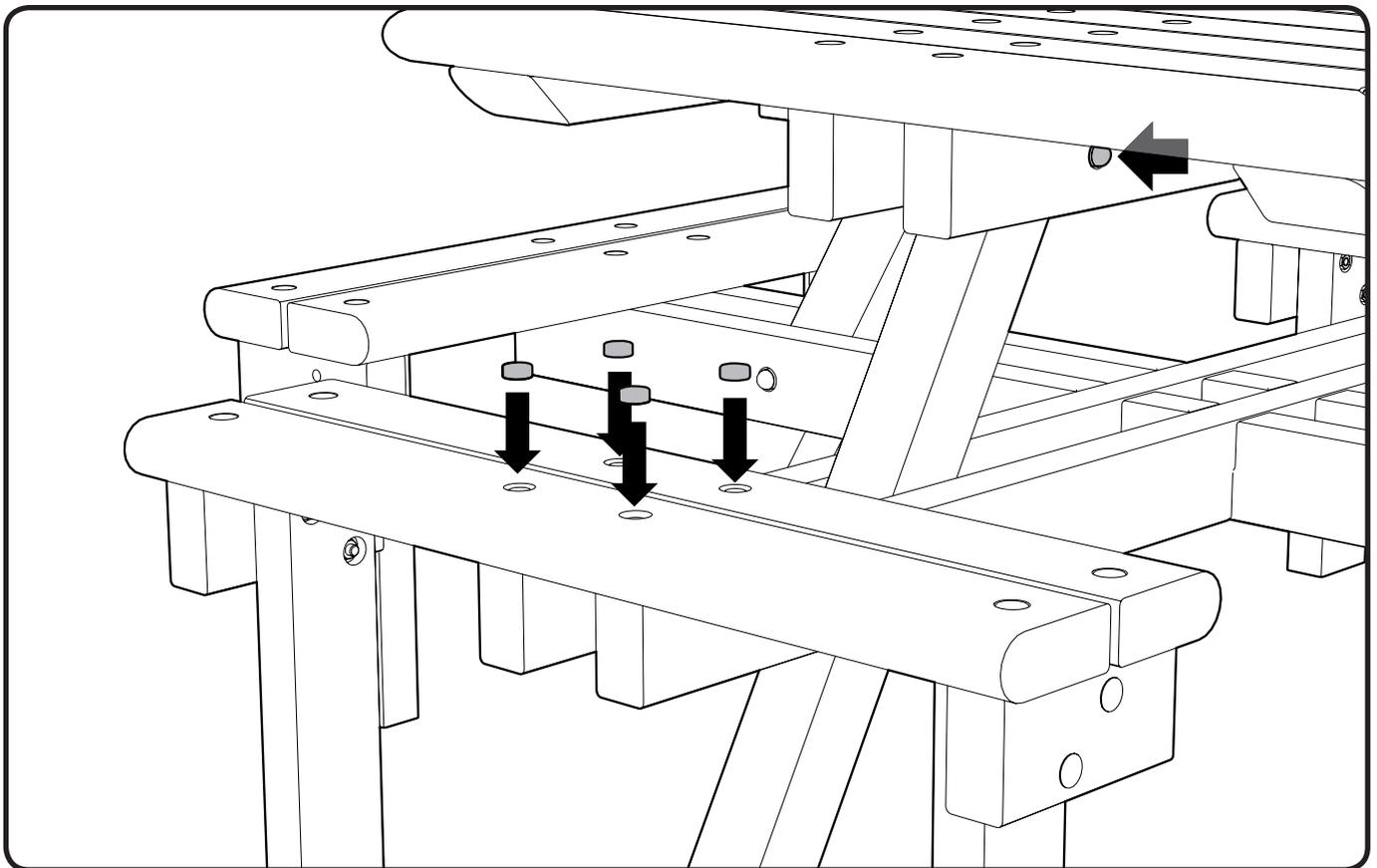
12. Coloque los embellecedores abovedados (Ítem 7) sobre las tuercas que fijan las patas (del paso 9). Finalmente, coloque los embellecedores (Ítem 8) en las fijaciones de los asientos (Puede requerir un mazo). **MONTAJE COMPLETADO.**
