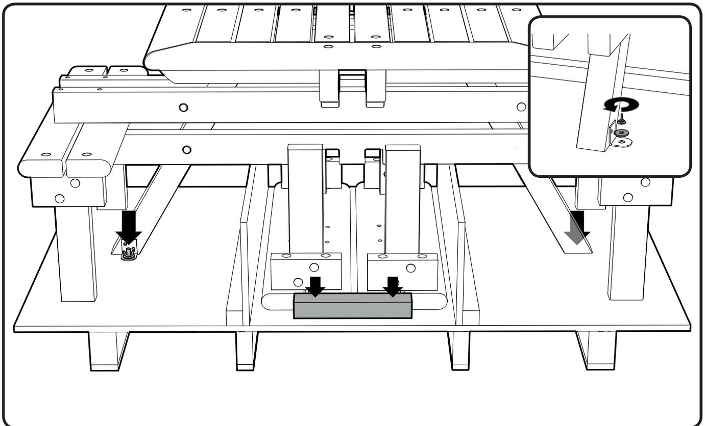
2. Utilice el taladro o el destornillador para desatornillar las fijaciones que sujetan los bloques de madera que aseguran los asientos durante el tránsito. Quite las 2x tuercas de mariposa que sujetan las patas al palé.
