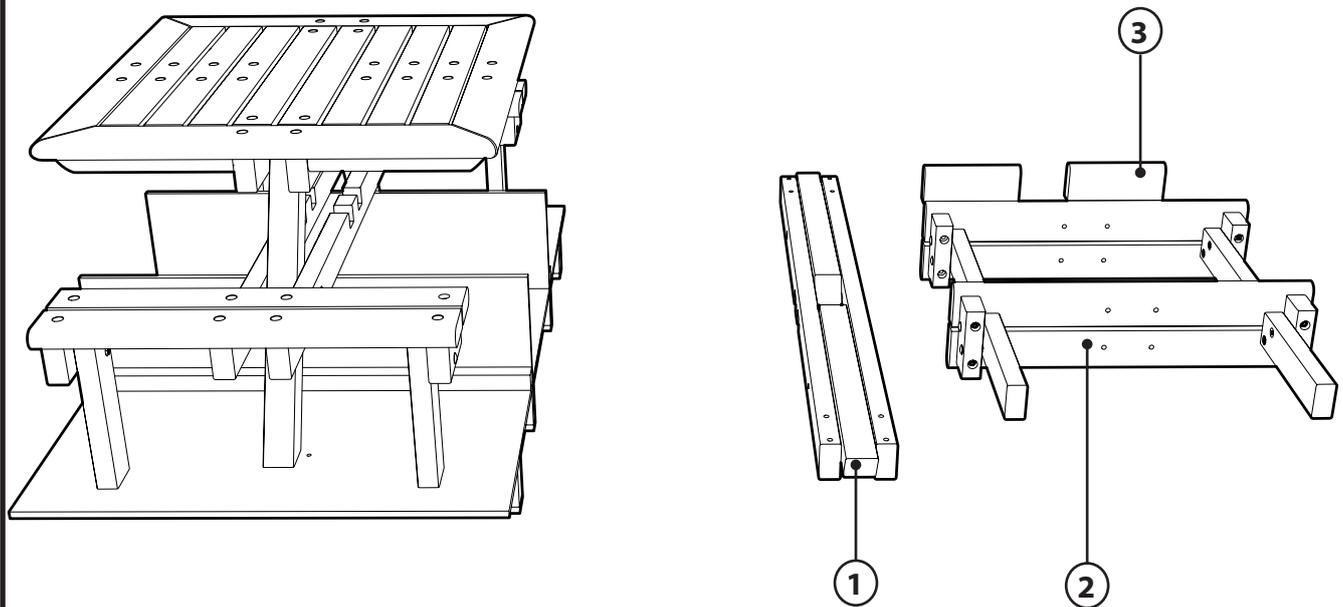
3. Saque cuidadosamente el travesaño, el montaje de patas (Ítem 1), el montaje de asientos (Ítem 2) las peanas (Ítem 3) y el kit de fijación del palé.
