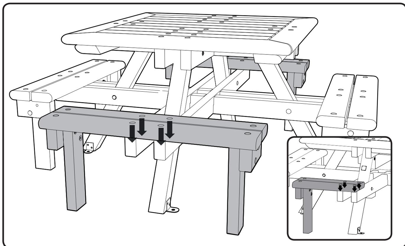
10. Ajuste las fijaciones a la mitad de las patas. Coloque los asientos (Ítem 2) en posición como se muestra. Alinee los cuatro agujeros en los asientos con los agujeros al final del travesaño y patas.
