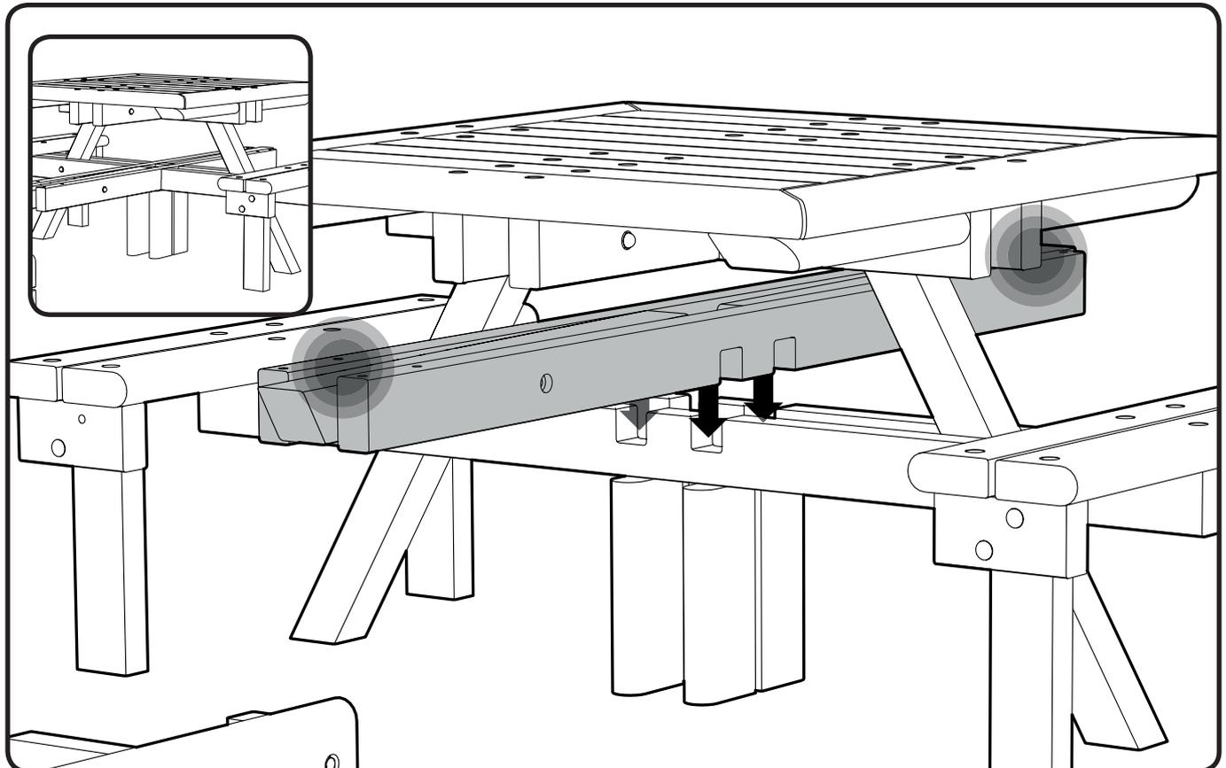
6. Introduzca el travesaño y las patas a través de la tabla de la mesa y colóquelo en las juntas a media madera correspondientes del travesaño inferior. Tenga cuidado de orientar el travesaño y las patas correctamente, con las juntas a media madera orientadas hacia abajo.
