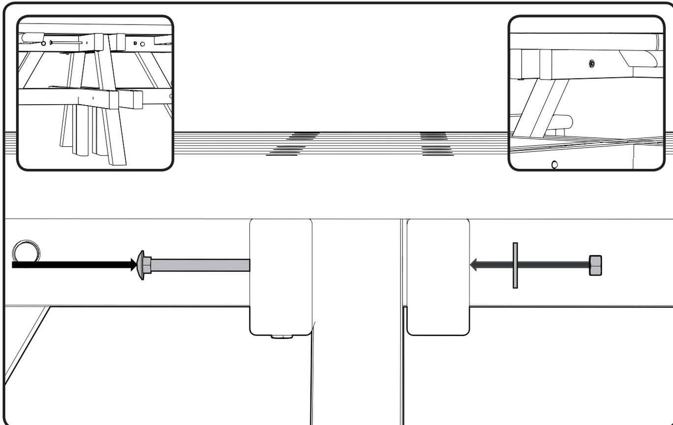
9. Inserte los tornillos M10 x 180mm (Ítem 4) a través del soporte de la tabla superior y la parte superior de las patas. Tenga cuidado de insertar la fijación a través del agujero más pequeño y no el de mayor tamaño. Asegure con una arandela (Ítem 5) y una tuerca (Ítem 6). Utilice una llave de tubo de 17mm para ajustar las tuercas.
