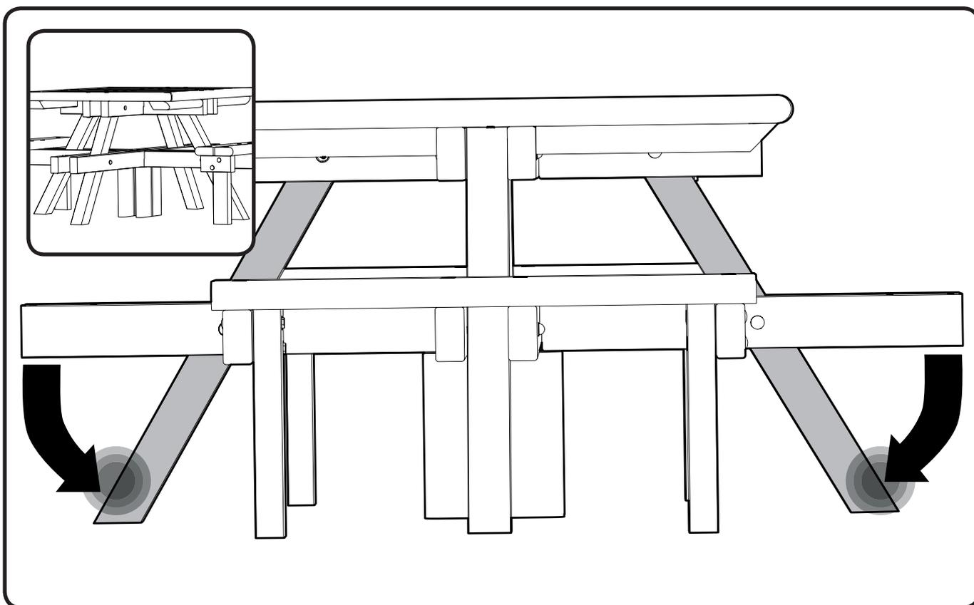
8. Gire las patas hacia abajo del travesaño y patas. Alineé los agujeros de fijación entre la parte superior de las patas y la parte inferior de la mesa golpeando la base de cada pata con un mazo hasta que se alineen. Quite las peanas.
