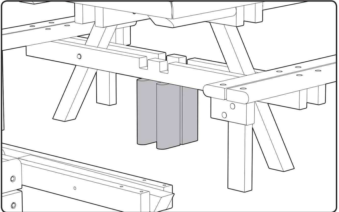
5. Coloque las 4x peanas (Ítem 3) entre el travesaño ajustado y el suelo, directamente debajo de las juntas a media madera.
