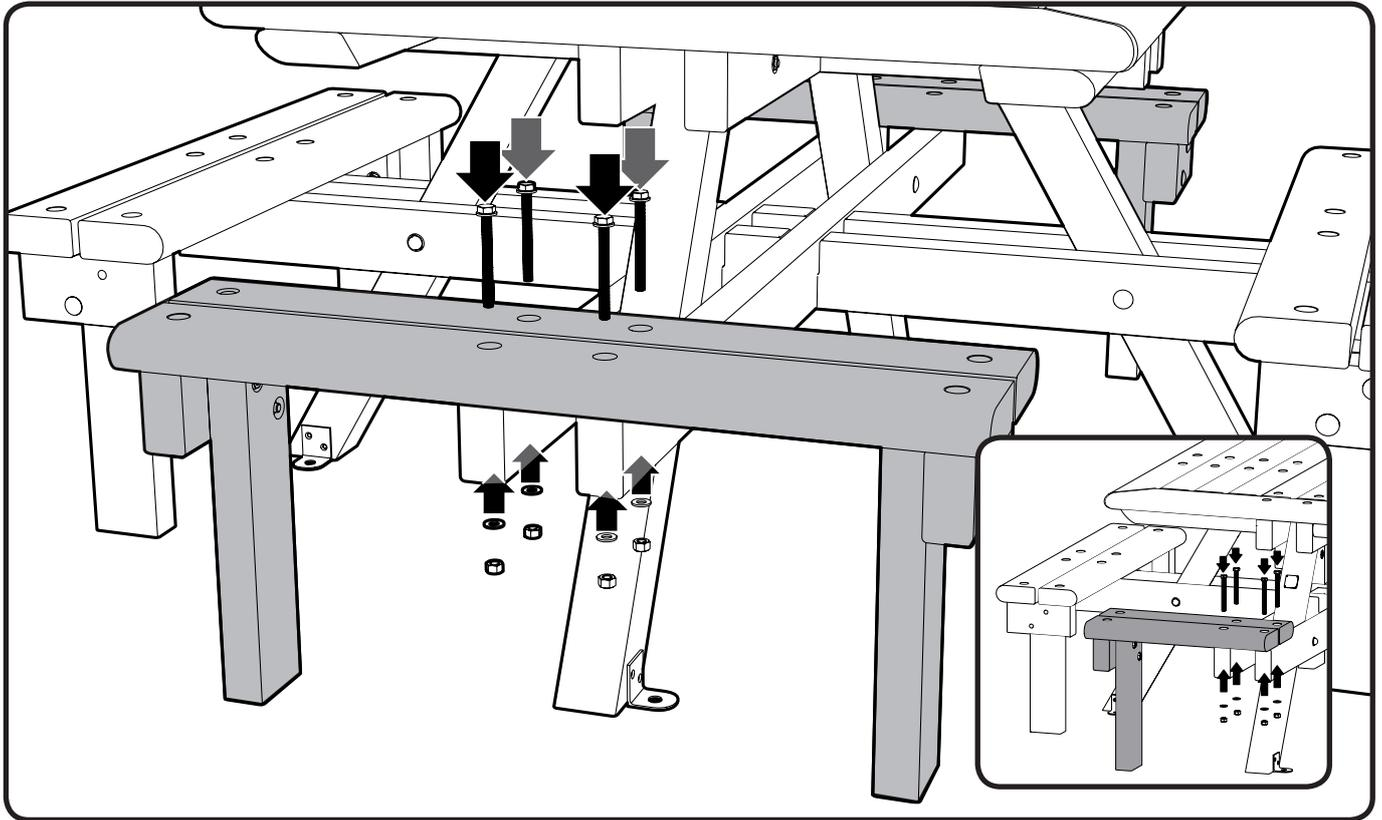
11. Inserte 4 tornillos M10 x 130mm (Ítem 9) a través del asiento y travesaños (Puede requerir un mazo). Asegure en posición utilizando las arandelas (Ítem 5) y tuercas (Ítem 6). Utilice las dos llaves de tubo de 17mm para agustar las fijaciones. Repita para el asiento opuesto.
